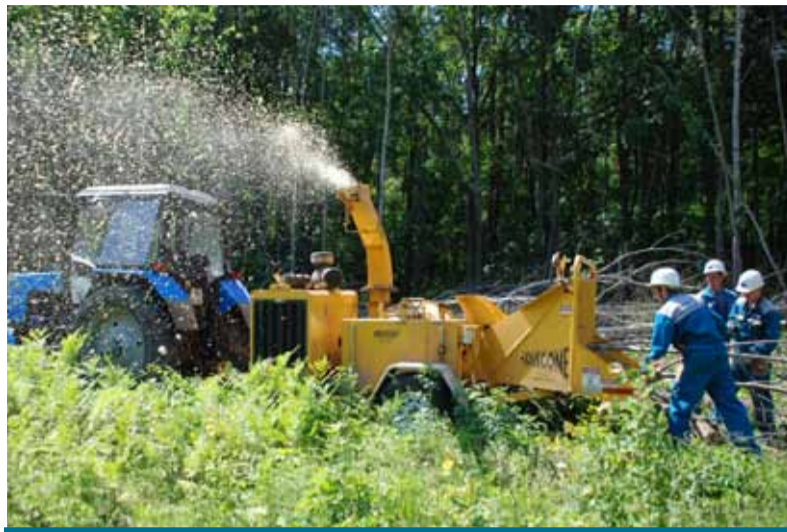
Работы по утилизации древесно-кустарниковой растительности ведутся при помощи мульчера
