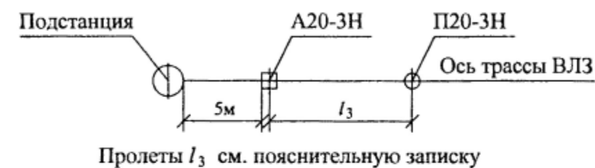
Схема 2 установки на ВЛЗ А20-3Н в качестве концевой опоры
