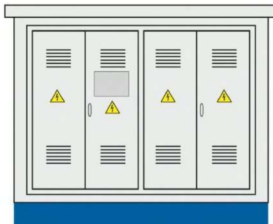
вид спереди КТП 6–10/0,4 кВ с бетонной кровлей
