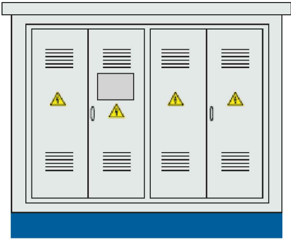
вид спереди КТП 6–10/0,4 кВ с бетонной кровлей
