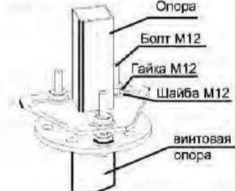
схема установки опоры
