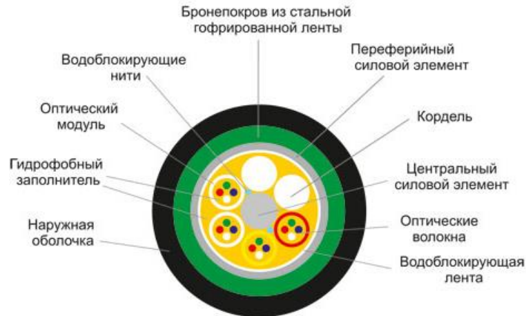
Рисунок 12. Пример конструкции ВОК для прокладки в зданиях
