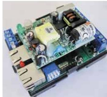
Модуль системы мониторинга трансформаторных подстанций
