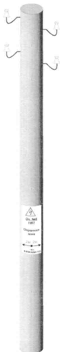
Промежуточная опора ВЛ-0,4 кВ
