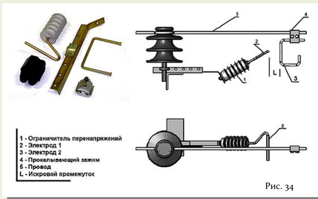
Устройства предназначены для защиты изоляции ВЛ от индуктированных перенапряжений и перенапряжений при прямых ударах молний с амплитудами до 65 кА.
