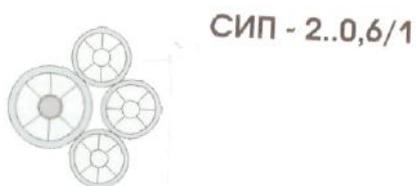
Для ВЛИ 0,4 кВ наряду с проводом СИП-2 применять провод СИП-5 (сечение 16-150 мм<sup>2</sup>).
