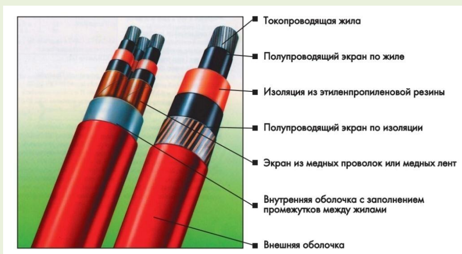
Конструкция кабеля с ЭПР изоляцией
