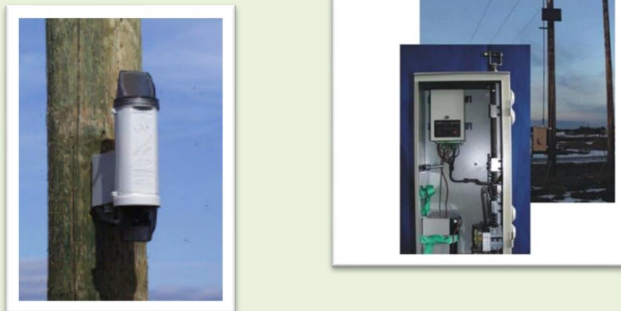
Индикатор мест повреждений воздушных линий LineTroll 3500
