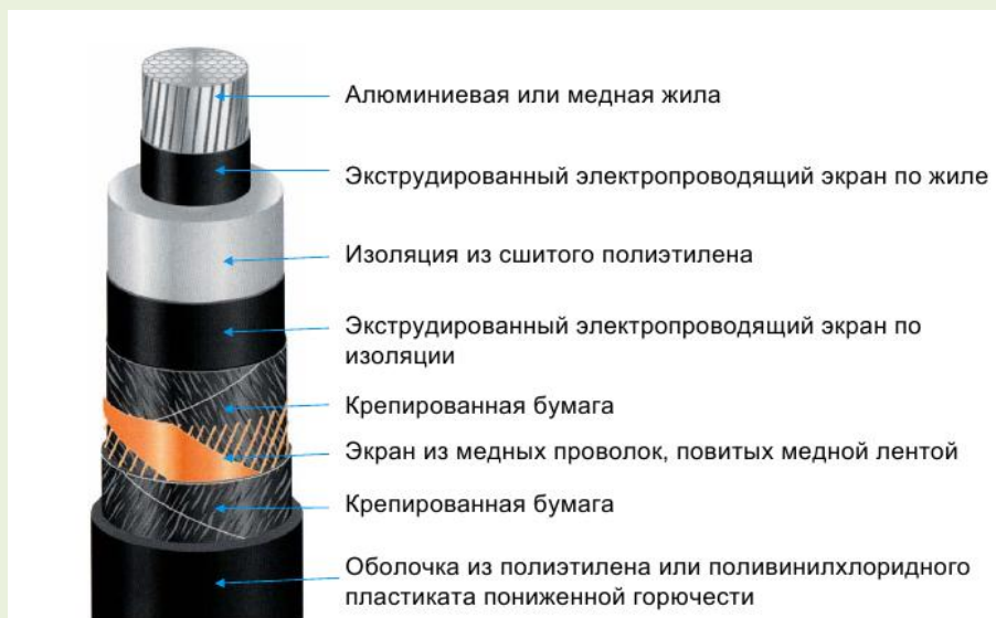
Конструкция СПЭ кабеля среднего напряжения
