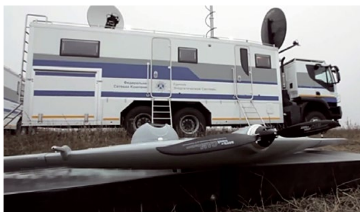
В течение светового дня с помощью беспилотного летательного аппарата можно обследовать до 30 опор линии электропередачи
