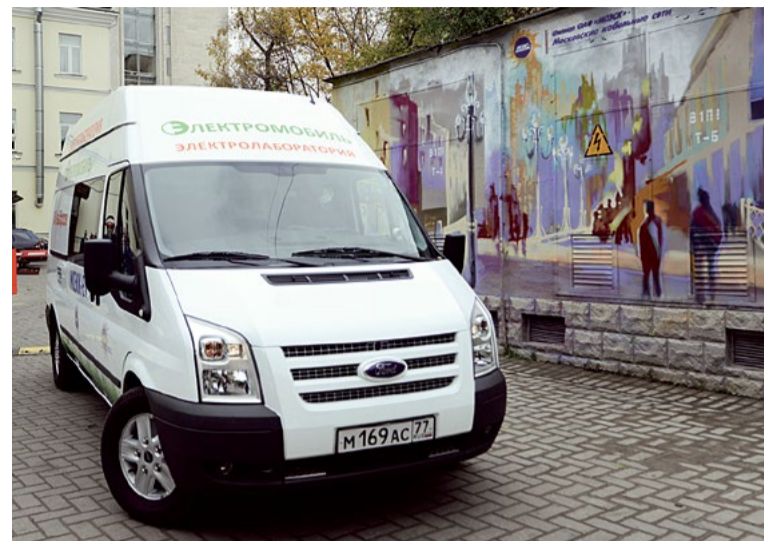
Энергетики МОЭСК используют электротранспорт и в производственной деятельности: на фото уникальная электролаборатория для диагностики повреждения кабельных сетей
